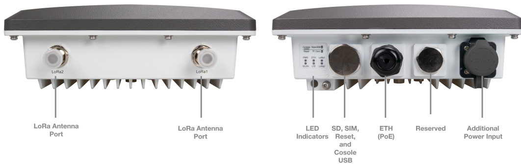
Figure 3: RAK7289 WisGate Edge Pro interfaces
