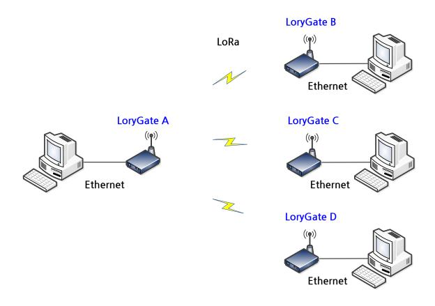
먼저 Channel 과 Spreading Factor 는 상호간에 같은 값으로 설정 한다. 마스터가 되는 LoryGate A 의 Destination ID 는 Broadcast 주소값인 16777215 값으로 설정한다. 이로서 다수의 LoRa 디바이스들은 모두 LoryGate A 의 LoRa 데이터를 받는다. 다수의 Lora 디바이스들은 Destination ID 를 LoryGate A 의 Source ID 로 설정 함으로 1:N 망을 구성 할 수 있다.
