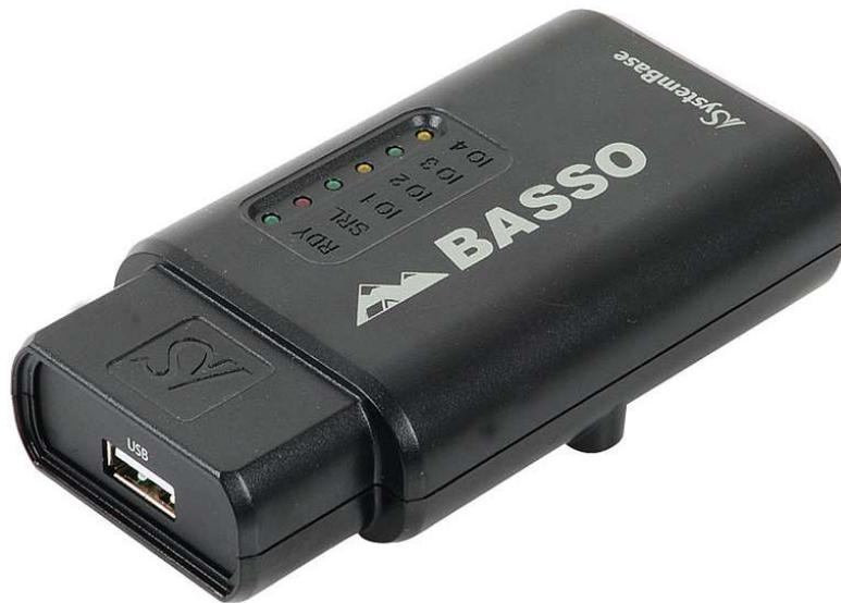
BASSO-1040UT/AI 는 산업현장에서 사용되는 온도, 압력 등 아날로그 센서 데이터의 전압/전류 값을 입력 받아 USB 인터페이스로 변환해주는 USB to AI(Analog Input) 제품이다.
